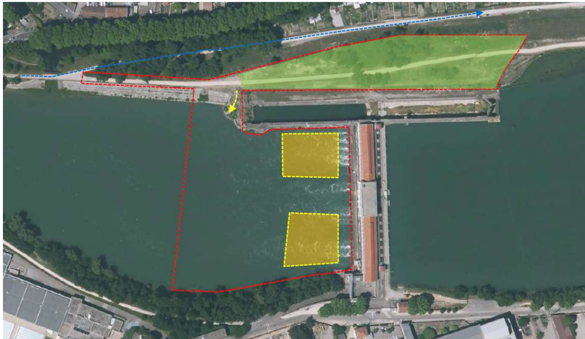
Figure 1 : Emprise du chantier (pointillés rouges) – zone d'installation de chantier (verte) – accès rivière (flèche jaune) – zone de travaux en rivière (zones orange -pointillés jaune), dérivation anneau bleu (pointillés bleus)
